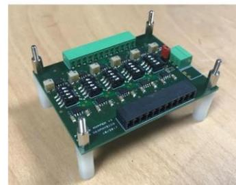
Figure 7 Préamplificateurs faible bruits
